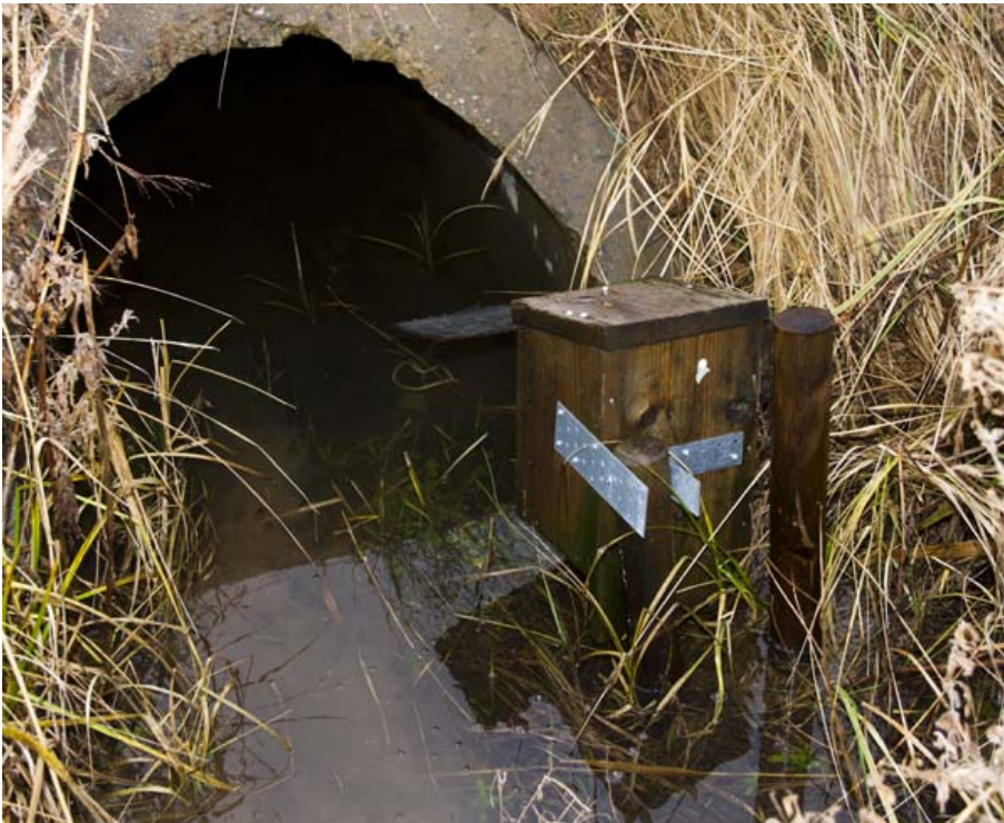
Figur 9. Kamerorna placeras i lådor, en i varje tunnelände. Lådorna sitter ute under hela säsongen och är mestadels tomma vilket förhoppningsvis minskar risken för stöld och sabotage. Något sådant har heller inte inträffat.
